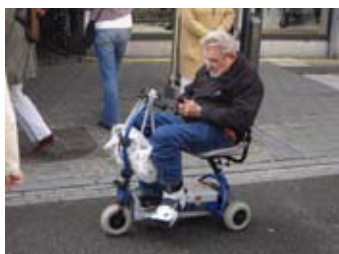
Fig. 2.1b Een scootmobiel is een driewielige of vierwielige scooter met een elektrische aandrijving welke hoofdzakelijk wordt gebruikt door mensen met een mobiliteitsbeperking.
