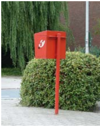
Fig. 2.1.1o Deze brievenbus is van boven veel breder dan op grondniveau tastbaar is. Een dergelijk obstakel hoort op de looprouten zeker niet thuis.
