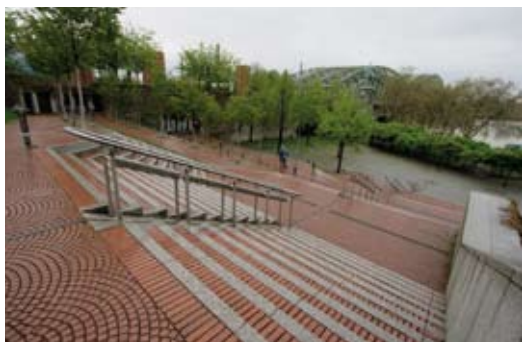
Fig 2.1.4y Bij deze lange trap heeft men tussenbordessen voorzien, waarop de traploper tussentijds kan uitrusten. De leuning had ten behoeve van blinde en slechtziende personen over de tussenbordessen door moeten lopen, zodat deze ook als geleiding zou kunnen dienen.
